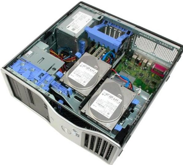
3. Enquanto prime a patilha de libertação para baixo (1) faça deslizar a moldura em direcção à parte superior do computador (2).
