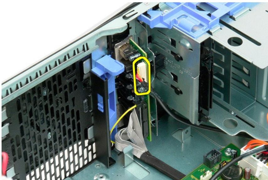
8. Retire o parafuso que fixa o painel E/S ao computador.
