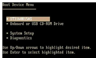
Tal como acontece com as plataformas das estações de trabalho Dell Precision™ anteriores, o seu computador inclui um menu de arranque de uma só vez. Esta funcionalidade oferece um método rápido e conveniente com o qual pode ignorar a ordem do dispositivo de arranque definido pela Configuração do Sistema e arrancar directamente para um dispositivo específico (por exemplo disquete, CD-ROM ou disco rígido).
