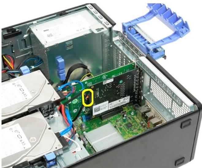
7. Levante a placa de expansão a direito para cima e retire-a do computador.
