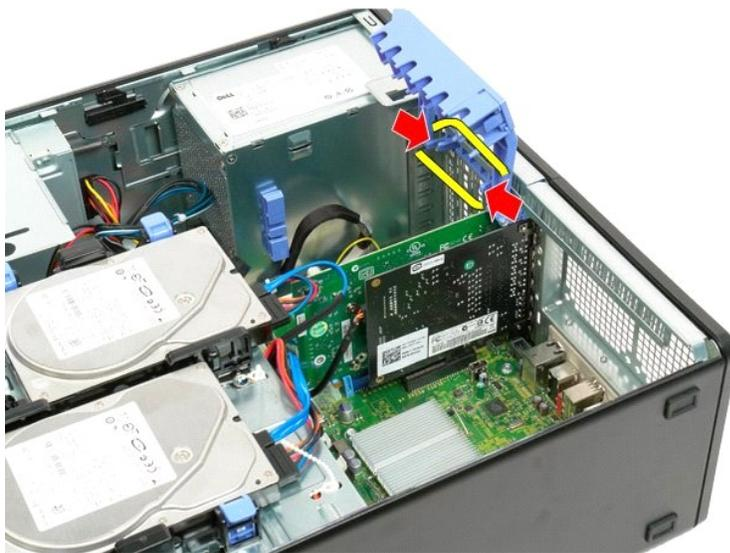
5. Continue a inclinar o conjunto de retenção da placa de expansão em direcção ao exterior do computador.
