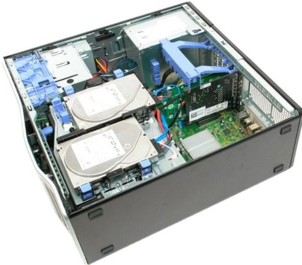
3. Levante o braço de retenção do conjunto da placa de expansão afastando-a do chassis.
