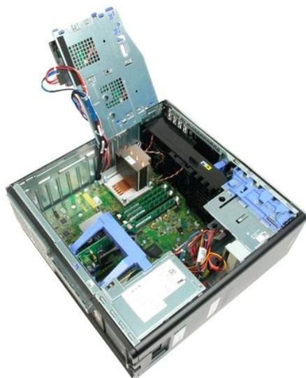
5. Desaperte os quatro parafusos integrados no dissipador de calor.
