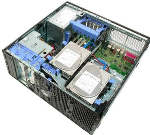
5. Desligue os cabos de alimentação e de dados da parte posterior da unidade óptica.
